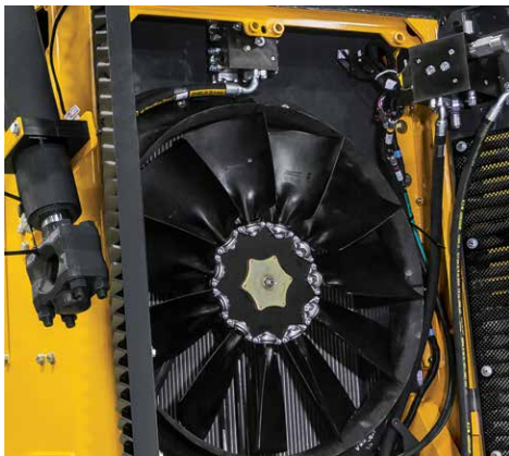
Hydraulic-driven cooling-system fan
