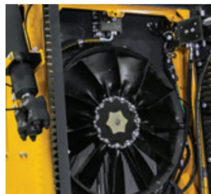
Hydraulic-driven cooling-system fan
